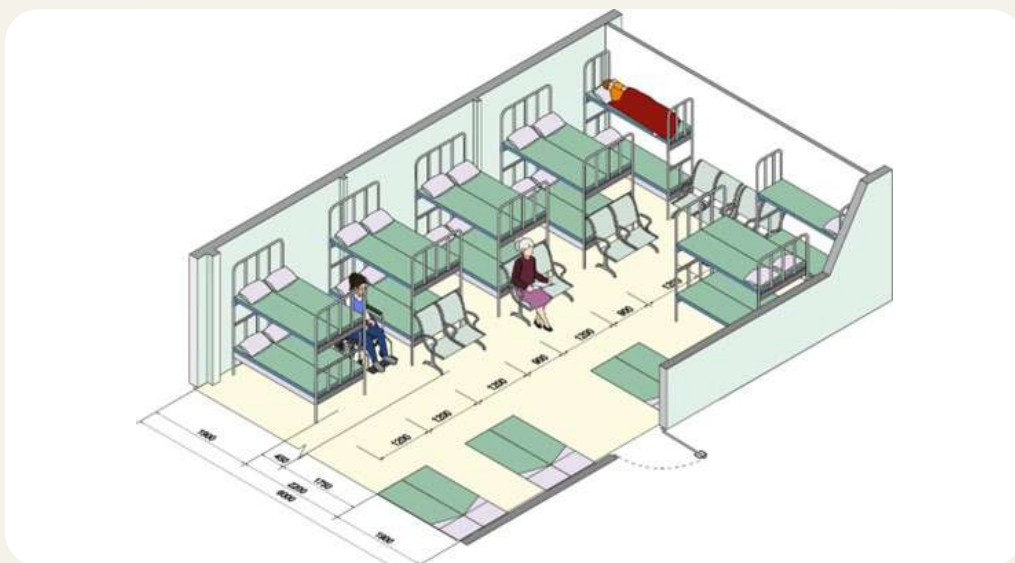
Рисунок 2.6. Схема облаштування укриття житлового будинку
