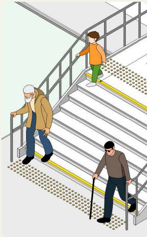
Рисунок 1.15. Приклад облаштування поручнів на сходах
